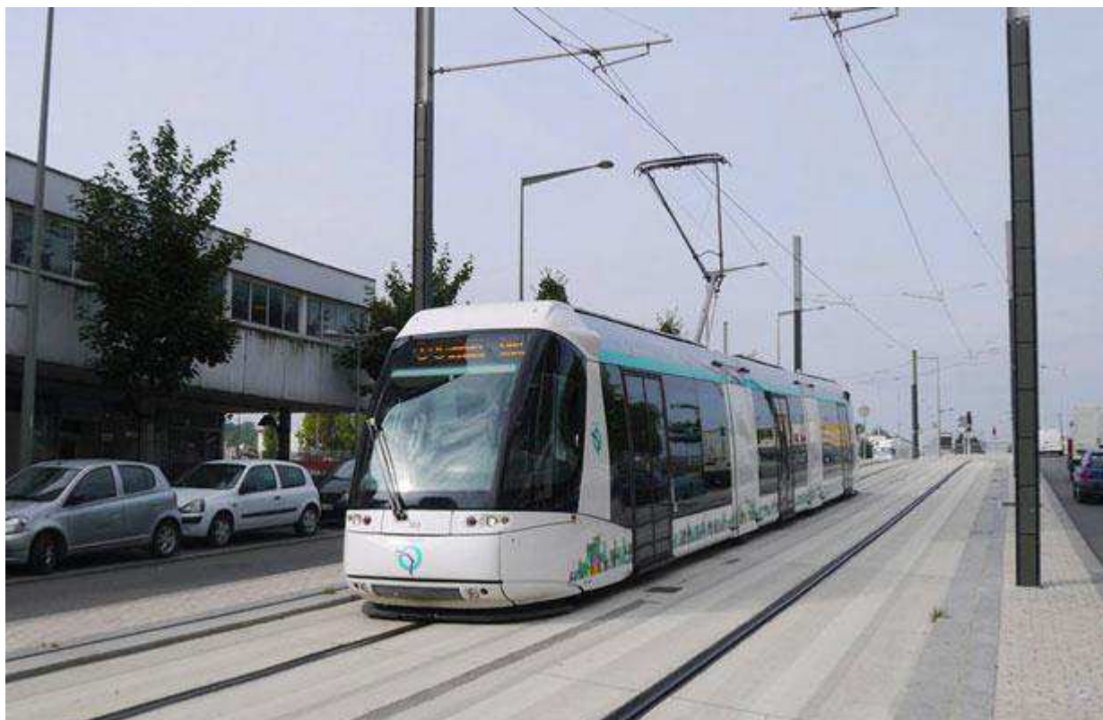
Un exemple de tramway sur pneus: Le T5, en région parisienne NEW TRANSLHOR (NTL)
